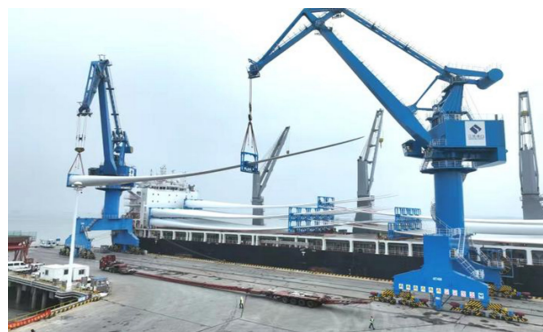
图 5 码头门座式起重机吊装叶片
