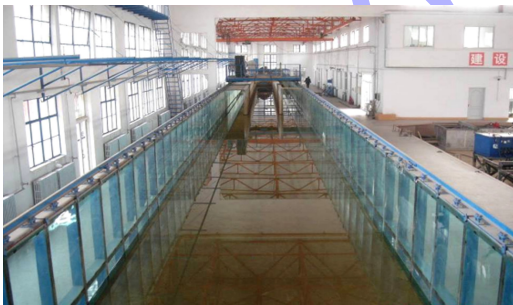
图 2 物理模型试验水槽
