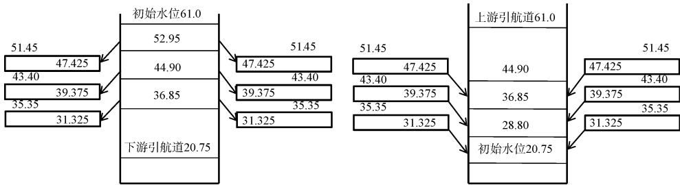
图2 整体式省水布置方案蓄水池设置 (单位: m)
