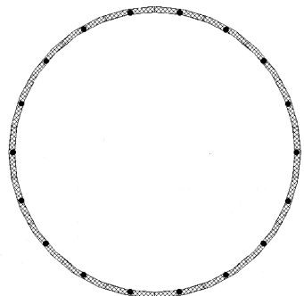
图 3 钢管桩截面纤维布置
