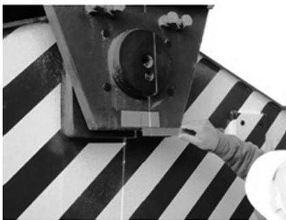
b) 测量激光与小车中心线的偏移距离
