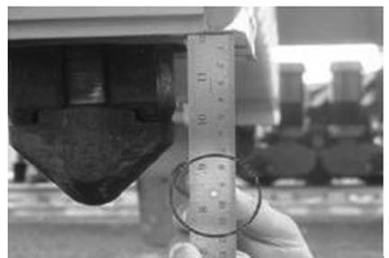
d) 对准吊具锁头平面的钢尺靶打水平激光
