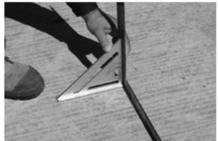
b) 用直角尺和折边直角方尺搭出测距目标
