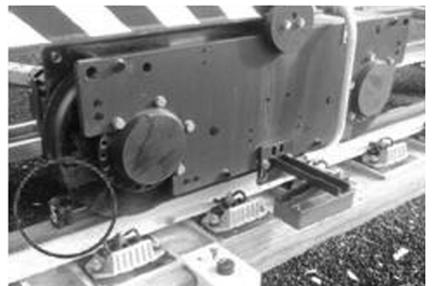
c) 激光自垂直发射器放在大车轨道上
