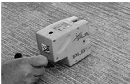
b) 将激光对准靶心, 并在地面标记对应的激光位置
