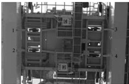
a) 小车架下4只滑轮轮缘的中心位置, 粘贴磁性激光靶
