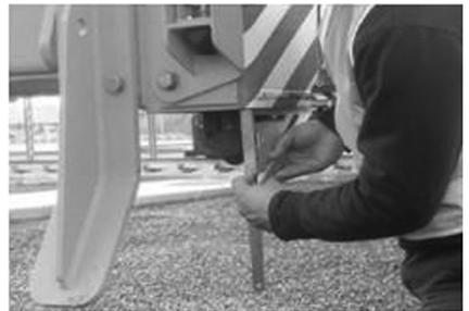
b) 用折边直角方尺和钢尺，在吊具锁头平面制作一只激光靶
