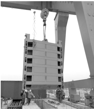
图1 工作阀门自振特性试验状态
