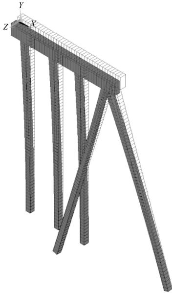
图2 排架第一阶位移振型
