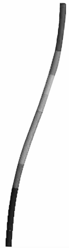
图 10 灌注桩水平位移
