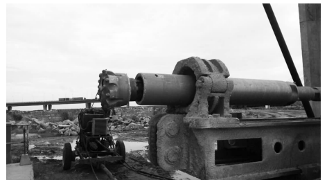
图3 高频冲击潜孔锤钻头
