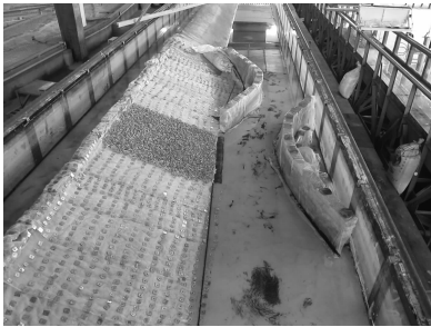
a) 水流顶冲岸坡防护试验设置
