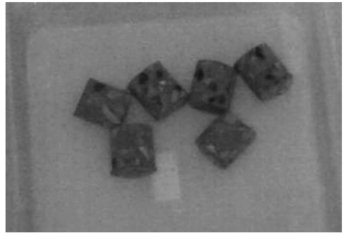
图 5 将混凝土芯浸水 30 min
