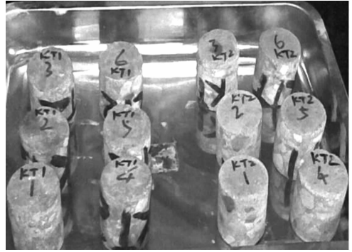
图 4 干燥冷却后的混凝土芯
