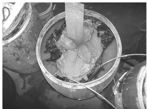
图 4 抽真空 3 d 形成“土柱”
