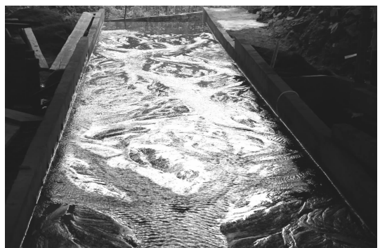
图2 大比降卵砾石河流股流形成试验
