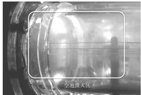
图10 主阀后空泡溃灭情况
