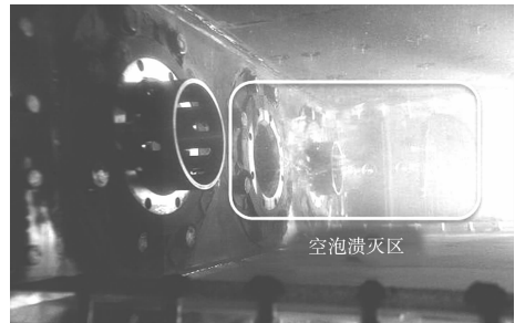
图10 主阀后空泡溃灭情况
