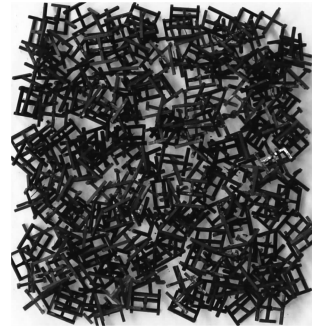
图10 透水框架模型均匀抛投后的光学图像
