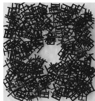
图12 透水框架模型留有空档抛投后的光学图像
