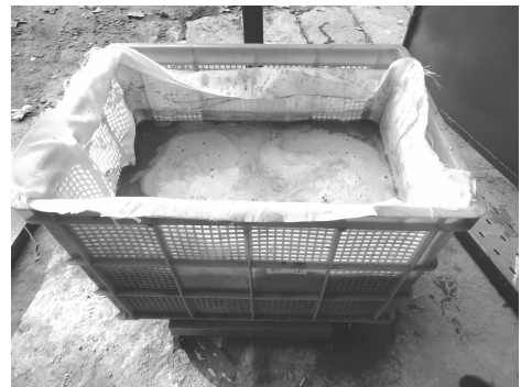
图 1 充填袋土排水试验照片
