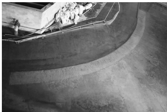
图5 50 a一遇洪水过后的河床地貌及泥沙淤积全景
