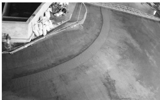
图6 优化体型后的动床模型照片及铺沙范围
