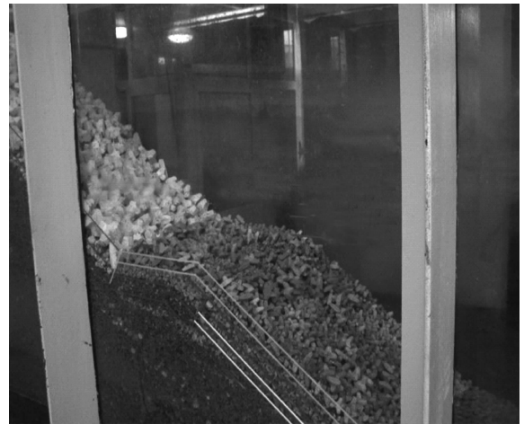
图 3 断面 2 肩台坡肩处破坏情况
