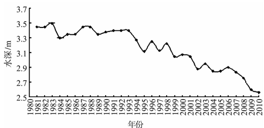
图 1 梧州水文站设计流量 1\ 140\ \text{m}^3/\text{s} 对应水位趋势线
