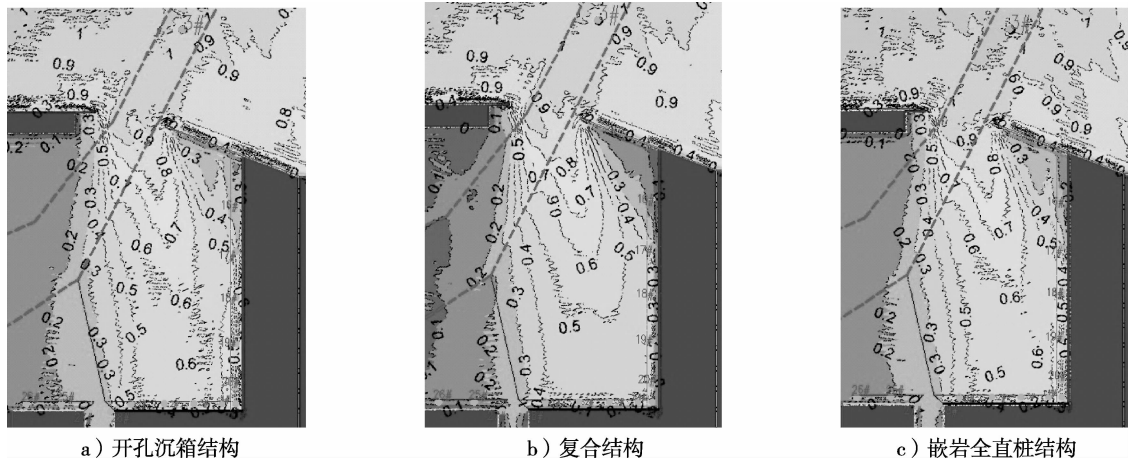
图 10 方案3 不同码头结构下 ENE 向 2 a 一遇设计高水位港内比波高分布
