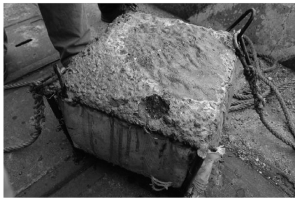
图4 同步灌注的小型模袋混凝土情况
