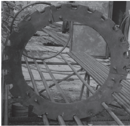
图3 钢筋笼子制作定型模具
