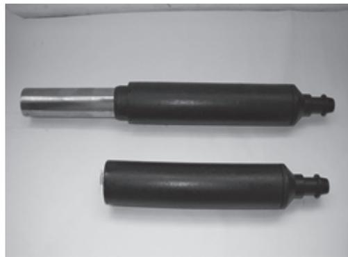
图4 水压固定活塞式薄壁取土器
