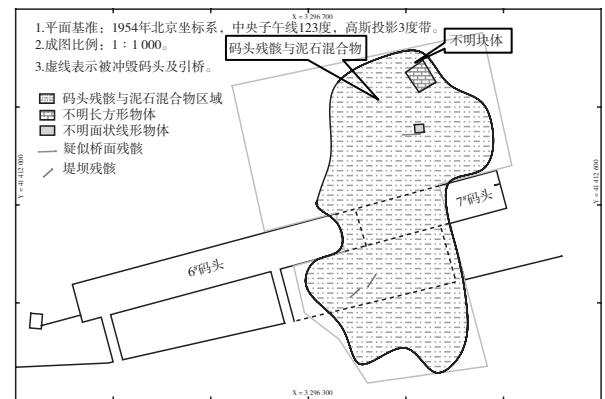
图4 7#码头扫海测量图
