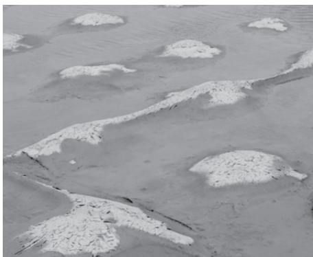
图1 竖向排水道附近的“土桩”
