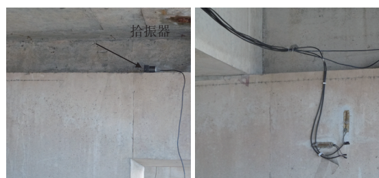
图1 拾振器及应变计现场布置
