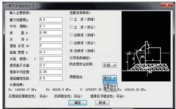
图4 防波堤压力计算参数输入界面
