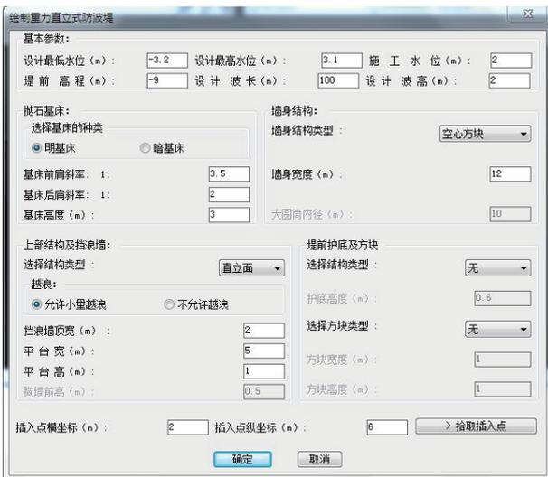
图5 防波堤断面参数输入对话框界面
