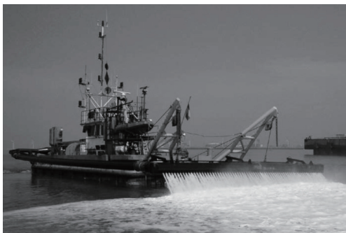
图2 Parakeet加装射水疏浚作业功能
