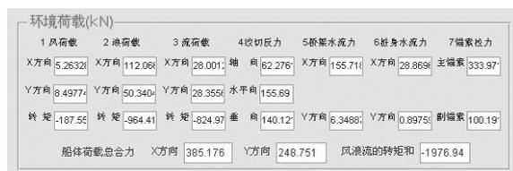
图5 具体工况下风浪流荷载计算结果
