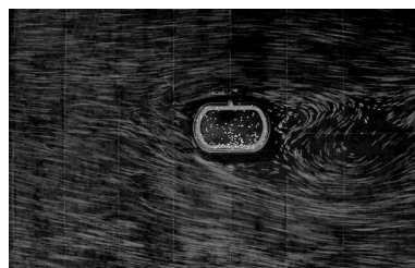
图9 建成后落急 (T=22 h) 流态照片
