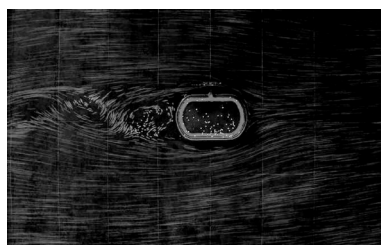
图8 建成后涨急 (T=15 h) 流态照片
