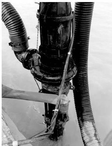
图1 新型取砂清淤装置
