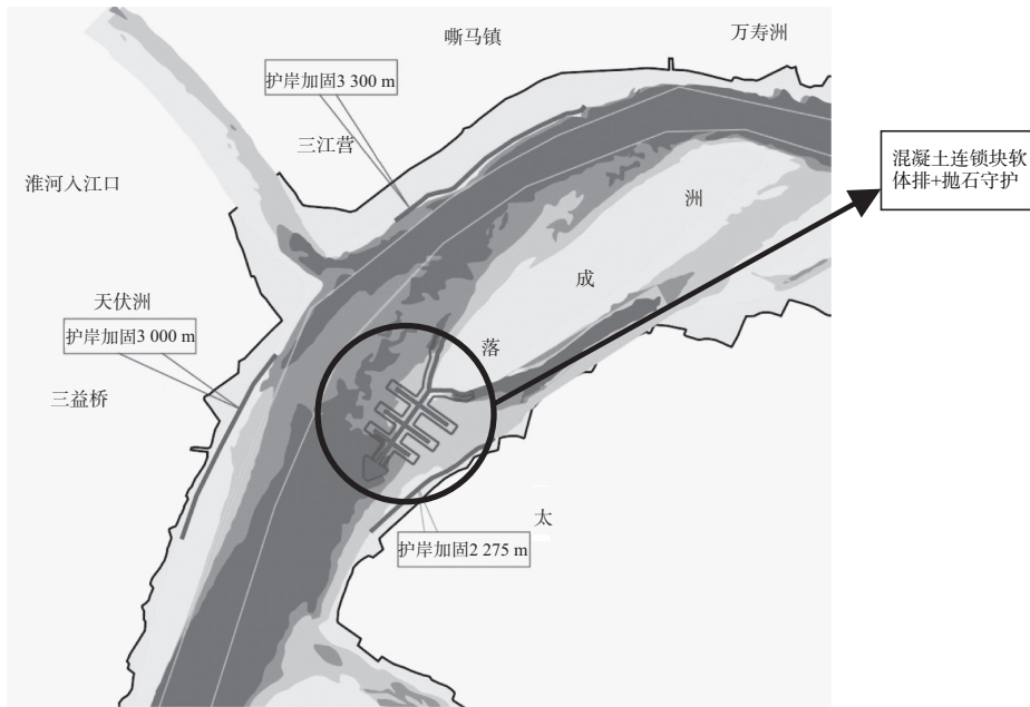
图1 航道治理落成洲守护工程平面布置
