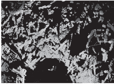
图9 透水框架三维图像声呐扫测
