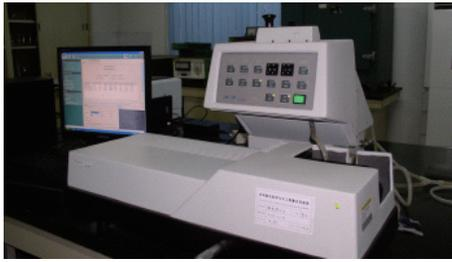
图5 EyeTech激光粒度仪
