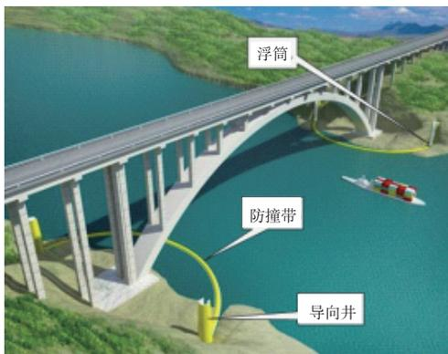
图2 弧形水上升降式防撞装置三维立体图
