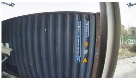
图 2 箱号箱型识别示意图
