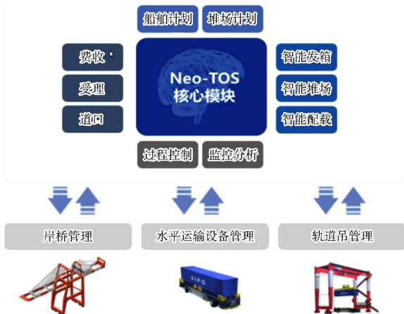
图 1 自动化码头管控系统架构
