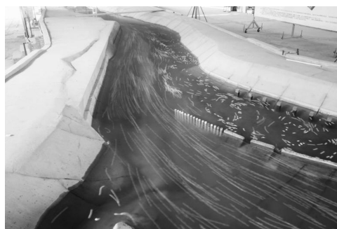
图 9 修改方案 3: 下游引航道口门区水流流态 ( Q=5\,000\text{ m}^3/\text{s} )
