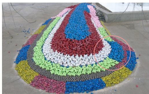
图 14 波浪作用后优化方案 4 堤脚损坏状况 Fig. 14 Damage condition of the breakwater toe after wave action for optimized scheme 4
