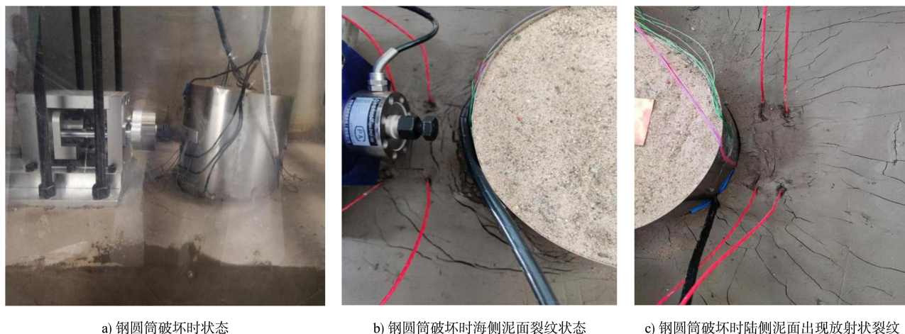
图 7 钢圆筒失稳破坏时的现象
