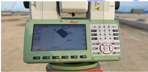
图4 道路堆场集卡通道土基面测量和验收
