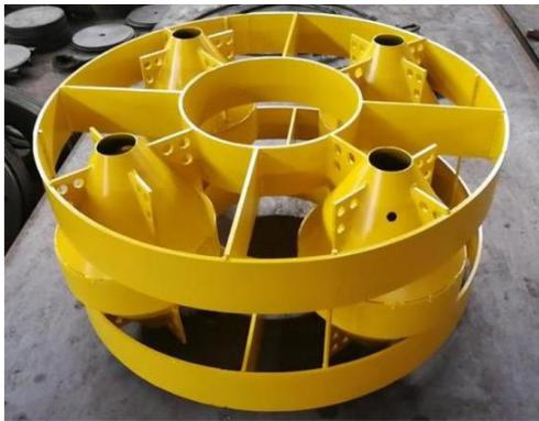
图 3 试验用环带形荷载箱
