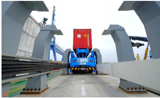
图 4 AGV 机会充电方式 Fig. 4 AGV opportunity charging mode
