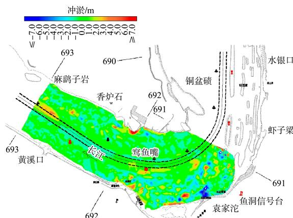
图 4 窯鱼嘴—虾子梁冲淤变化
