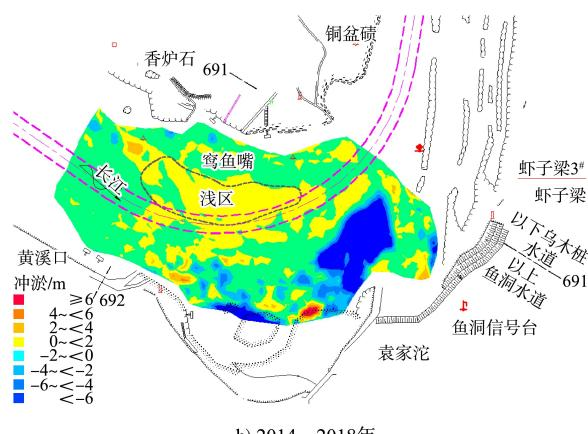
图 2 窯鱼嘴—虾子梁冲淤变化
