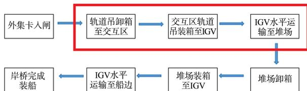
图 2 转接模式出口流程
