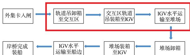
图2 转接模式出口流程
