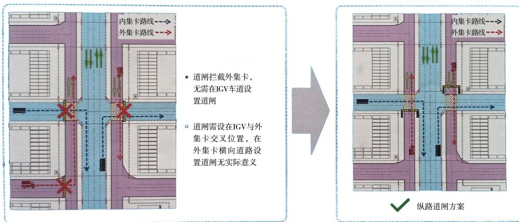
图9 纵路道闸模式堆场内路口设计
