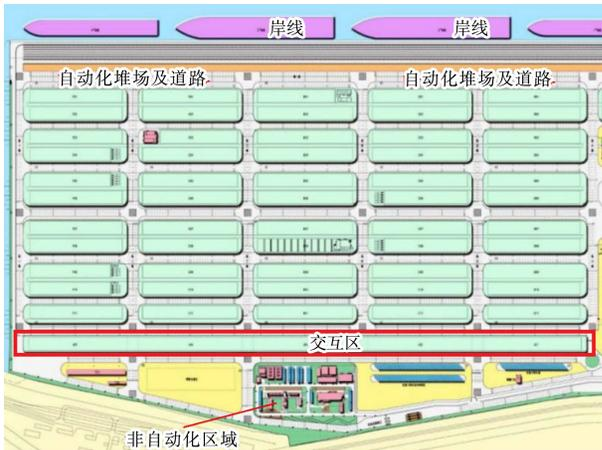
图 1 南沙自动化码头堆场平面
