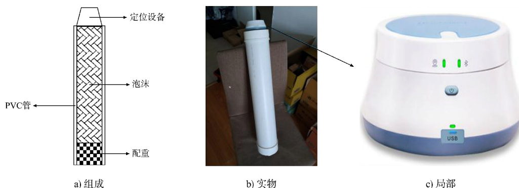
图2 新型表面流速流向测量浮标
