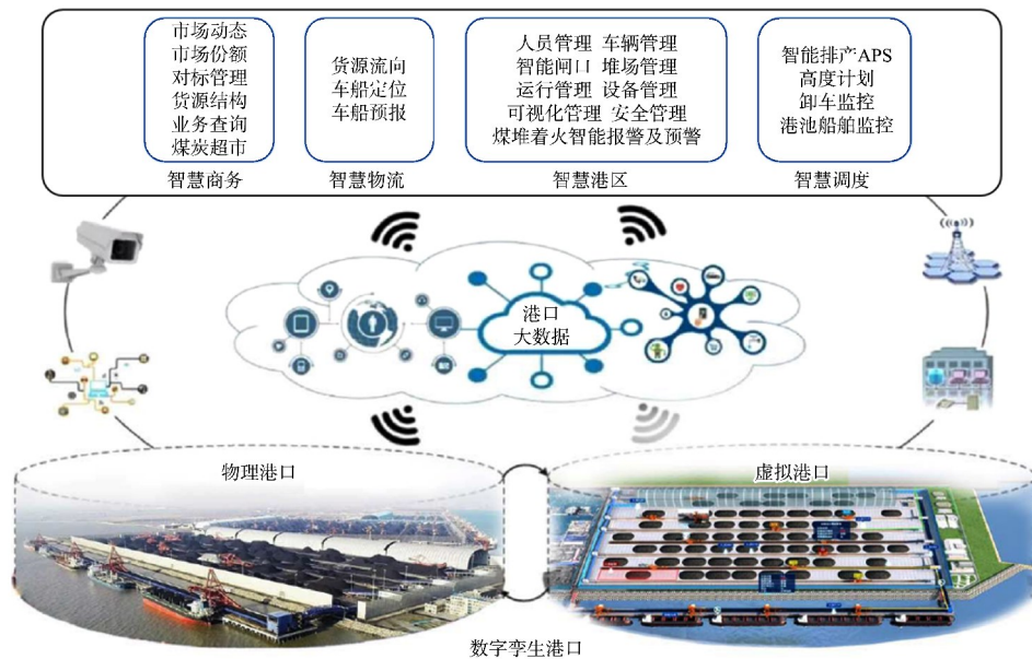
图2 煤炭港口数字孪生系统架构
