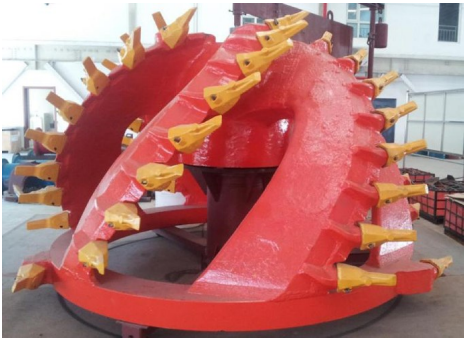
图 8 2 000 kW 绞刀实物
