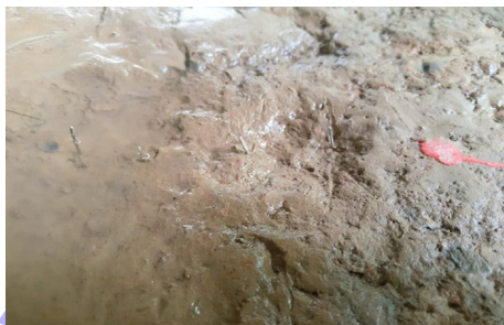
图8 试验后土体侵蚀针露出情况
