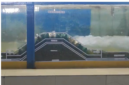
图6 断面物理模型卷破波作用于护底情况
