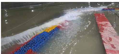
图7 整体物理模型极端高水位 50 a 一遇 SE 向浪卷破波作用于护底情况
